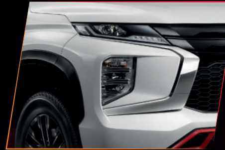
BI-LED PROJECTOR HEADLAMPS WITH BLACK EXTENSION AND AUTO LEVELING SYSTEM ไฟหน้าโปรเจกเตอร์ธรรมดา แบบ Bi-LED พร้อมระบบปรับลำแสงไฟอัตโนมัติ
